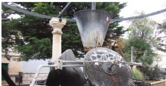
Fig.5: Molino de trituración de aceituna
